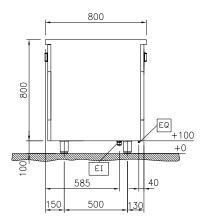
Electrical inlet (power) Equipotential screw
